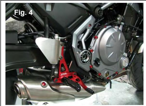
**4.** Montare la pedana sulla piastra di regolazione (viti M8 x 16), fissare la pompa e l'inclinazione paratacco (viti M8 x 30 testa bombata) e regolare l'altezza della leva. Quindi rimontare la cover di plastica con le viti originale e il distanziale h7 in dotazione. (Fig. 4)
