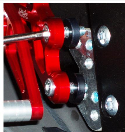
Avvitare la leva all'uniball utilizzando la vite e il distanziale forniti.
