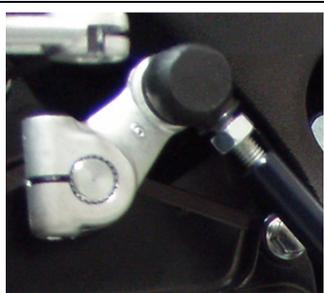
Per cambio normale utilizzare la bielletta originale. Per cambio rovesciato, utilizzare la bielletta in dotazione.
